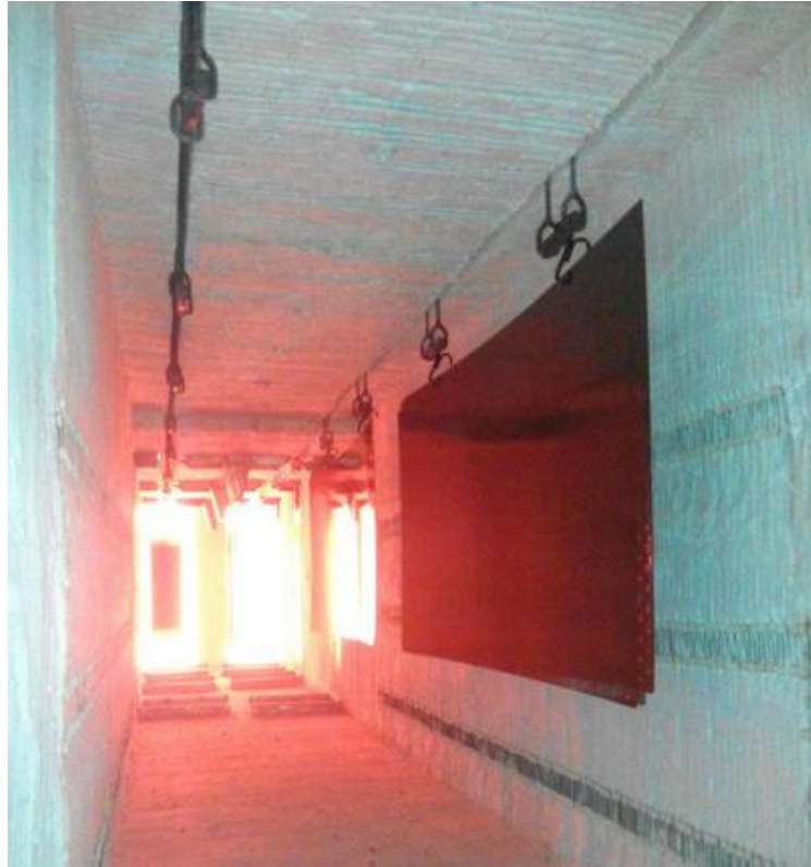
拼装罐钢板烧结实景
