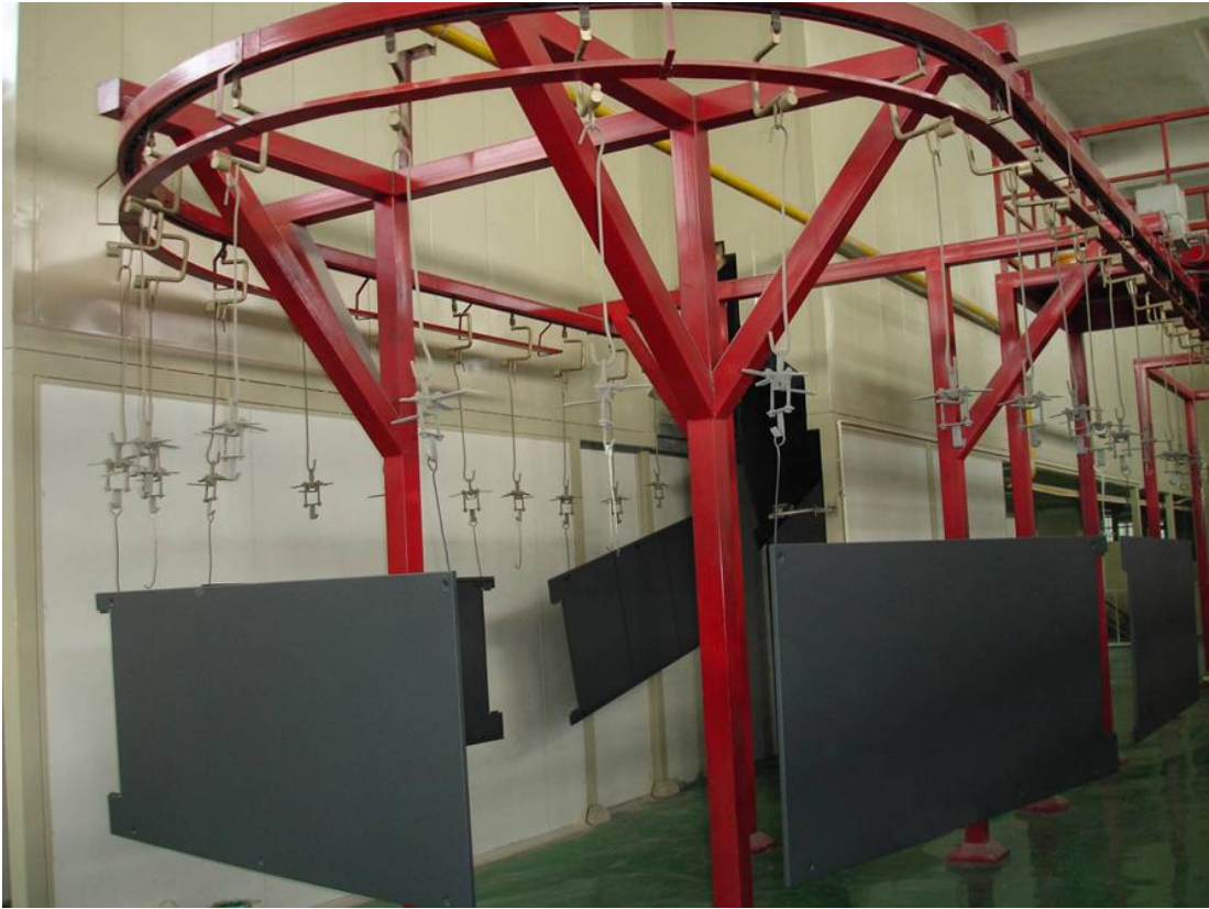
悬挂吊工输送线 (2)
