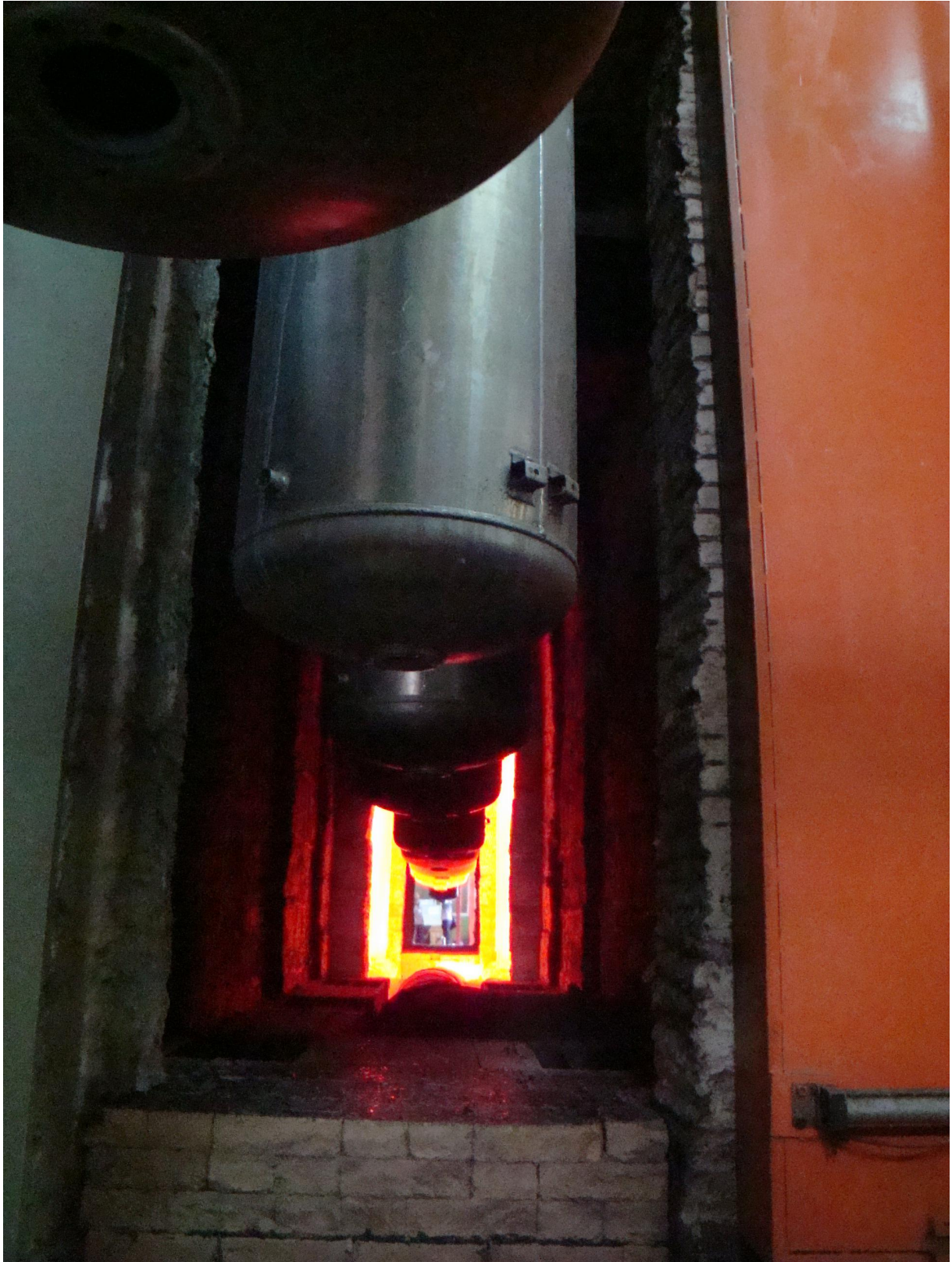
热水器搪瓷内胆烧结实景
