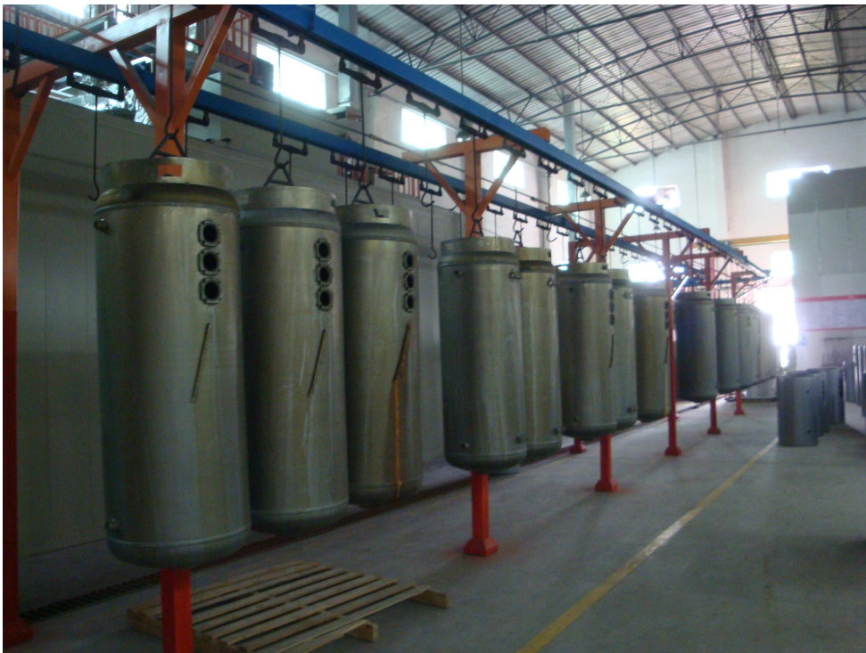
悬挂吊工输送线 (3)
