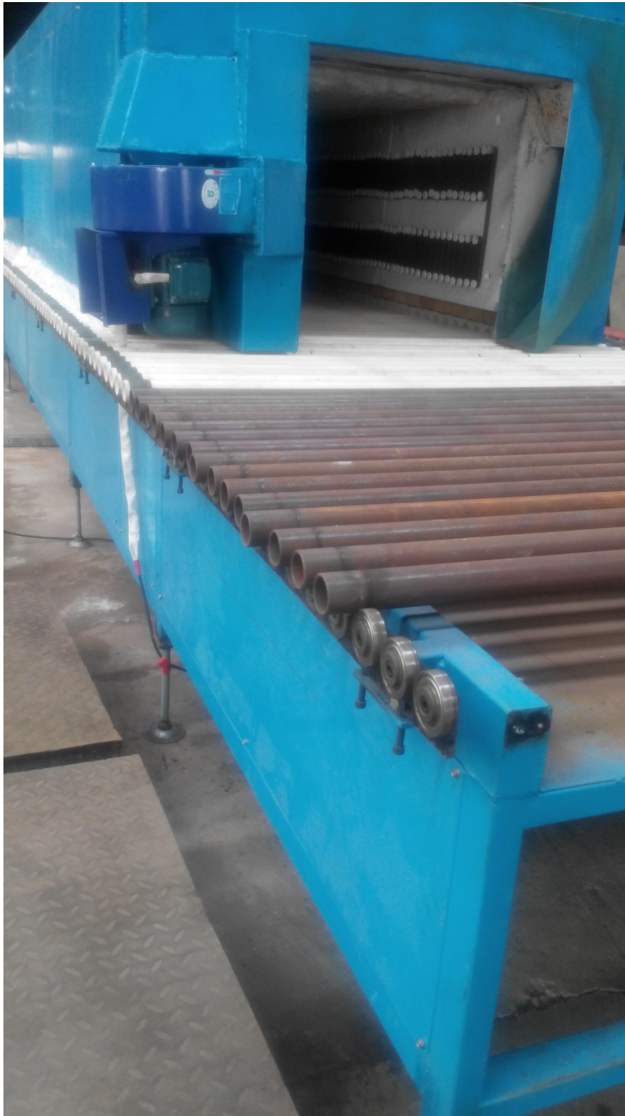
镍棒隧道烧结炉
